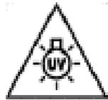
UV 輻射符號 IEC 60417-6040:2010 用於紫外線危害, 應為黃底黑字, 標示於光源發射處本體外殼位置。
